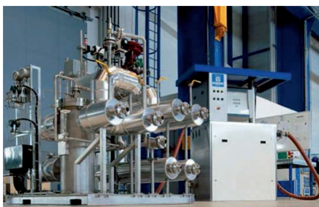
Pompa sommersa ed erogatore per impianti L-LNG
